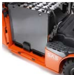
Vytiahnutie batérie pomocou zariadenia na zasunutie vidlíc
